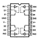
SW06BRC/883 LCC Package (RC-Suffix)
