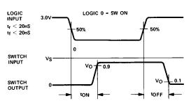
SWITCH OUTPUT WAVEFORM SHOWN FOR  $V_S$  = CONSTANT WITH LOGIC INPUT WAVEFORM AS SHOWN.  $V_O$  IS THE STEADY STATE OUTPUT WITH SWITCH ON. LOGIC INPUT IS INVERTED FOR SWITCH 1 & 2
